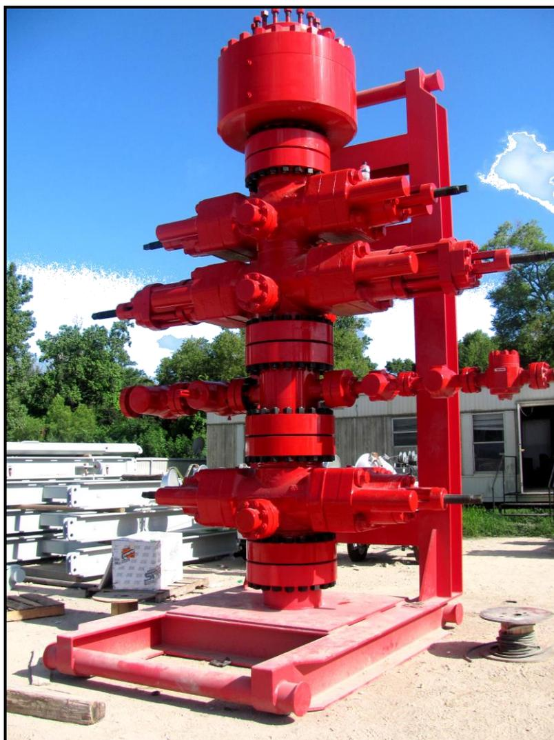
La testa pozzo, della fase di perforazione delle rocce del serbatoio, si completa con almeno una valvola laterale, installata sotto al BOP ed alla eventuale valvola maestra, a sua volta collegata ad una tubazione che permette di pompare fluido in pozzo per controllare la pressione in caso di necessità o gestire nella maniera voluta eventuali emissioni di fluido dal pozzo stesso.
