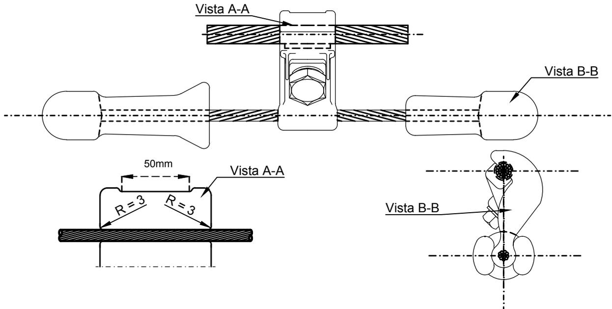
Morsetto ad un solo bullone del tipo "a montaggio facilitato".
