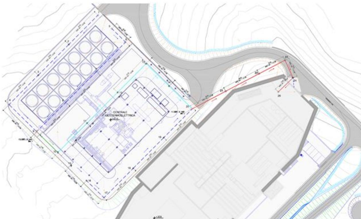
Figura 34: Sistema di raccolta e smaltimento delle acque meteoriche - Centrale (scala 1:800)
