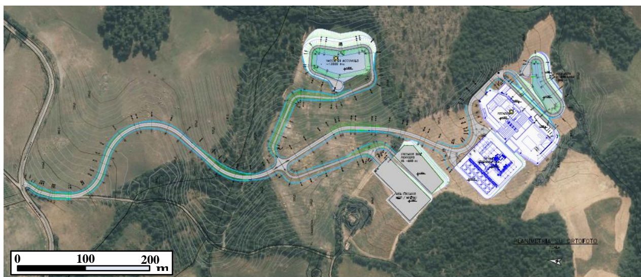
Fig. 2: foto aerea dell'area con planimetria dell'impianto e della viabilità di accesso.
