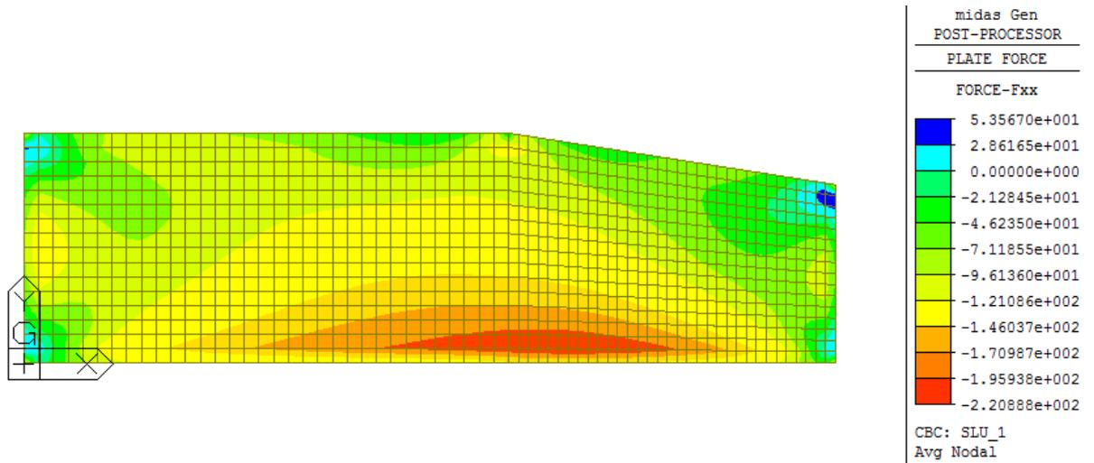
Figura 9 Diagramma del taglio nella soletta di base
