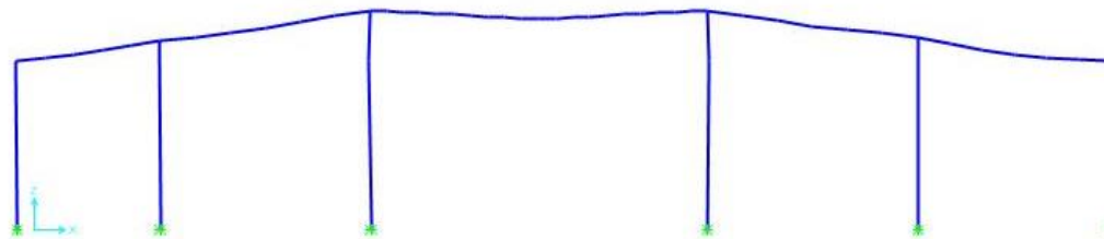
Figura 19 Deformata del portale per la combinazione rara
