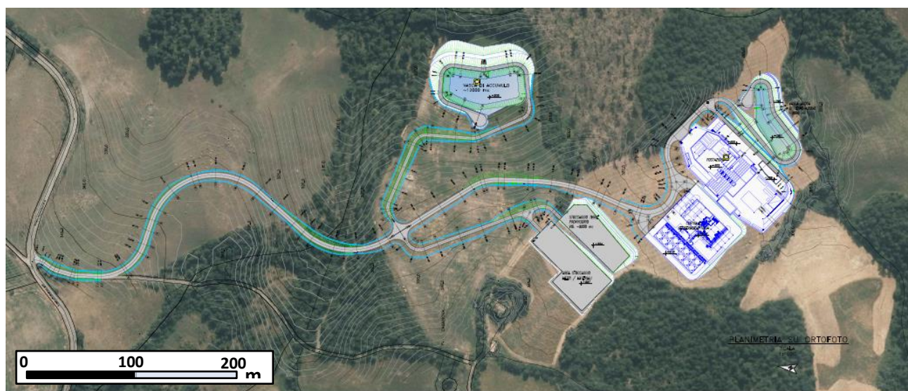
Fig. 4 - Layout complessivo del progetto definitivo dell’Impianto Geotermico Pilota Castelnuovo.
