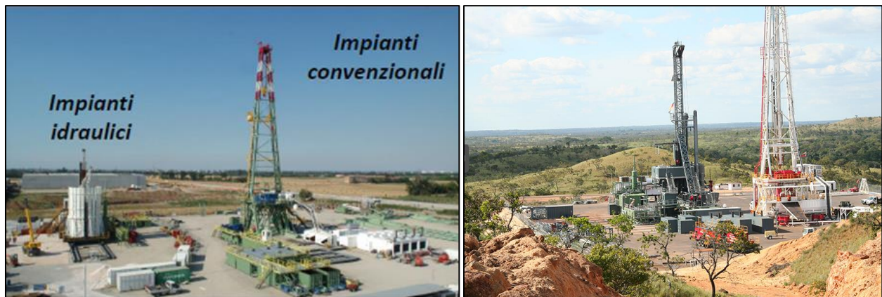
Fig. 19 – Confronto impianti di perforazione idraulici e convenzionali (fonte: www.drillmec.com e www.bauerdeepdrilling.com )
