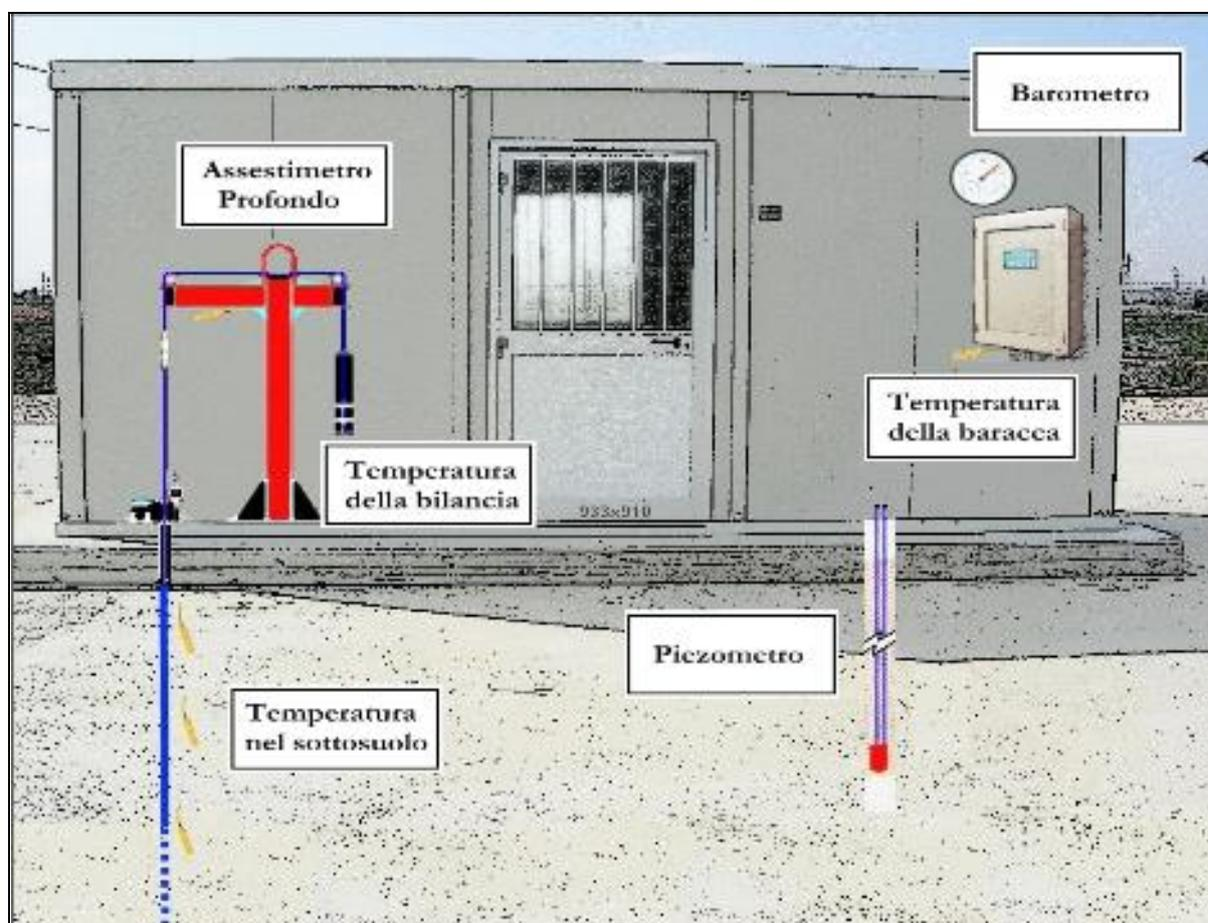
Figura 2B - Rappresentazione schematica di una stazione EPSU
