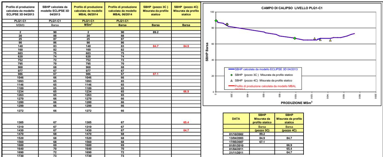
Figura 6 – Campo di Calipso: confronto tra dati di pressione da profili statici e modello Eclipse (livello PLQ1-C1)
