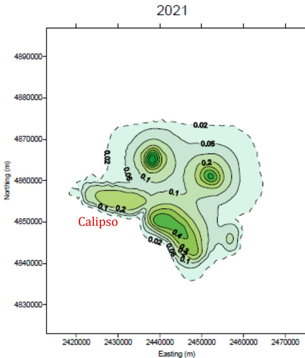
Figura 7 - Modello geomeccanico (settembre 2013): curve d'isosubsidenza per lo scenario di riferimento C<sub>m</sub>\_Med (subs. max. su Calipso: 33 cm @ 2021)
