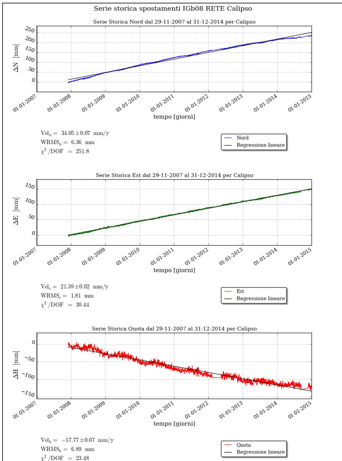
Figura 11 – Campo di Calipso: serie storiche plano-altimetriche CGPS
