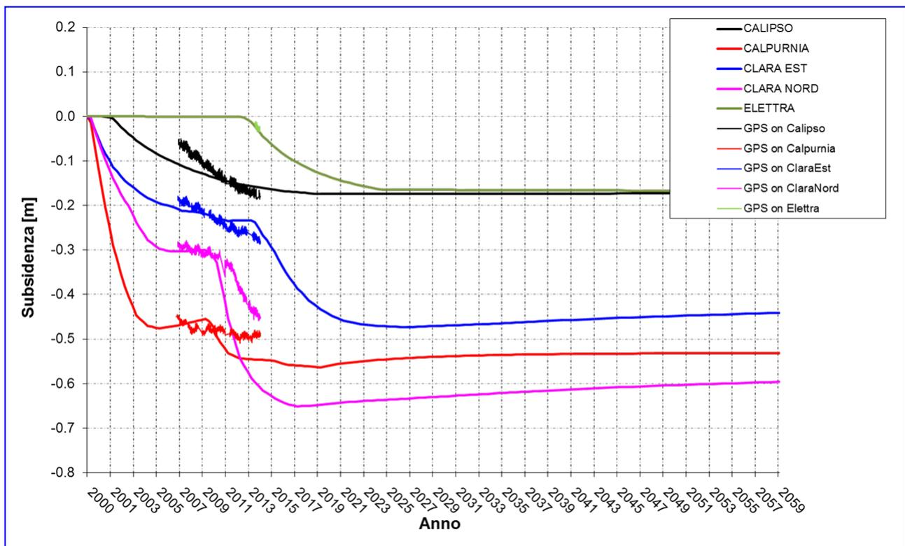
Figura 13 – Andamento temporale della subsidenza prevista da modello geomeccanico (settembre 2013) per lo scenario C<sub>m</sub>\_Med in corrispondenza delle piattaforme di produzione. Per Clara Nord, Clara Est, Calpurnia e Calipso le previsioni di subsidenza sono confrontate con le misure altimetriche da CGPS
