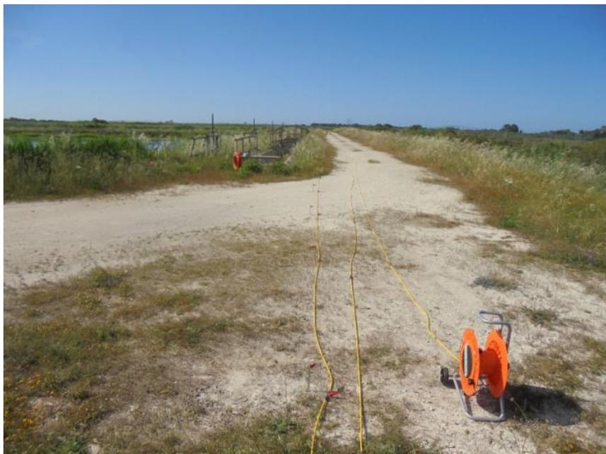
*Foto 4 - Melendugno. TAP. Prospezione geoelettrica. Profilo PR\_H.*
