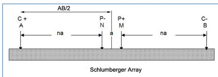
Figura 11 – Melendugno. TAP. Prospezioni SEV. Array Schlumberger.
