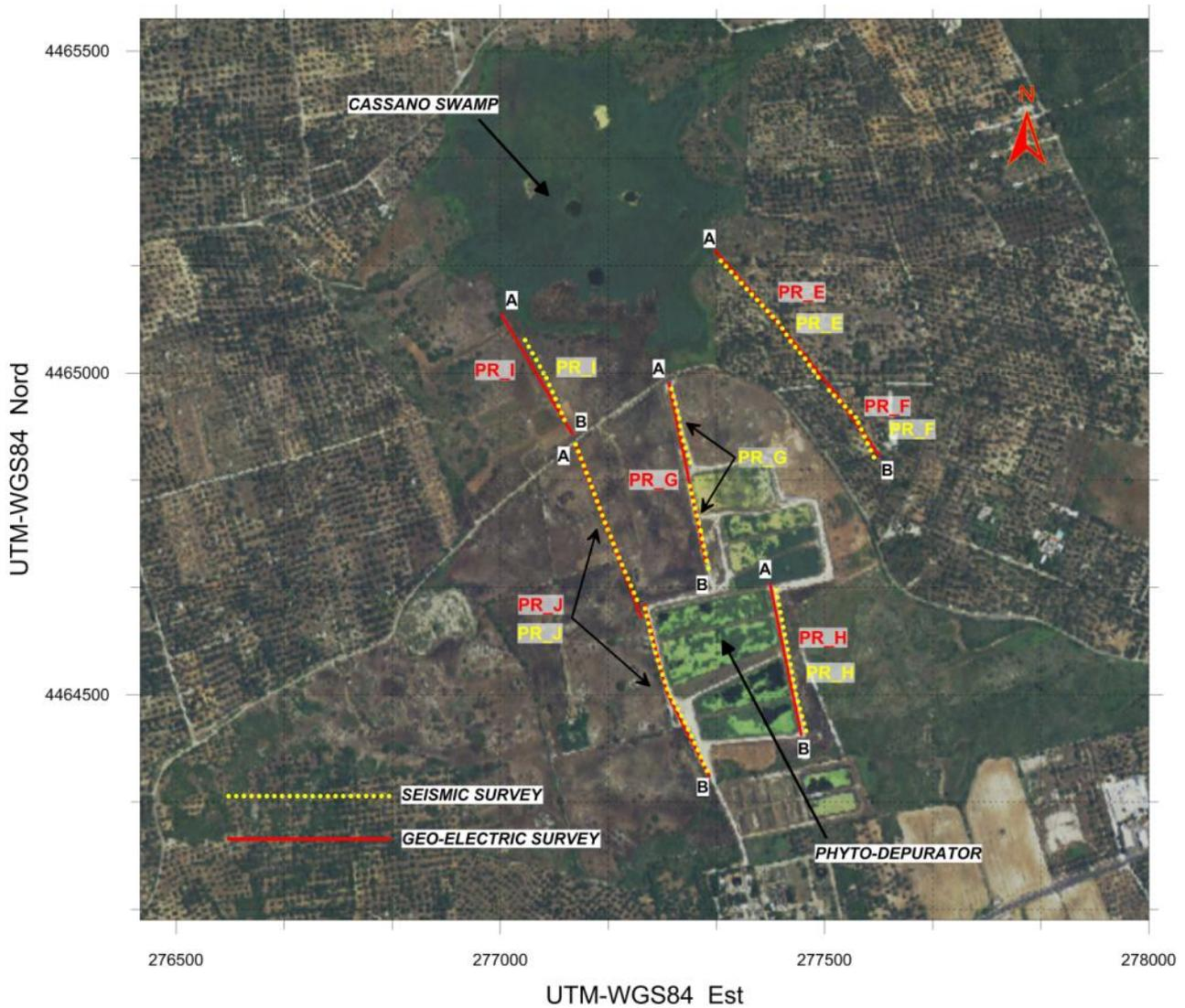
Figura 20 – Melendugno. TAP. Prospezioni geofisiche eseguite presso la palude di Cassano.
