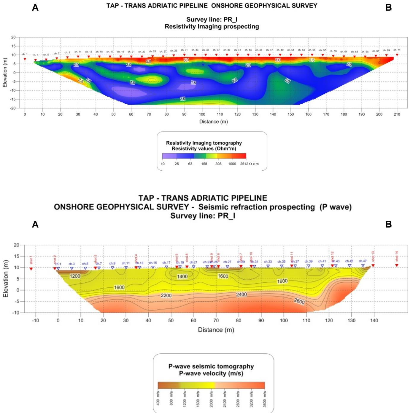
Figura 24 – Melendugno. TAP. Profilo PR\_I – prospezioni geoelettriche e sismiche a rifrazione.
