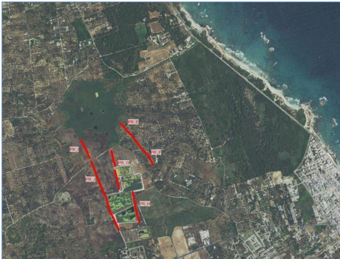
Figura 14 – Melendugno. TAP. Ubicazione delle prospezioni sismiche a rifrazione presso la palude di Cassano.
