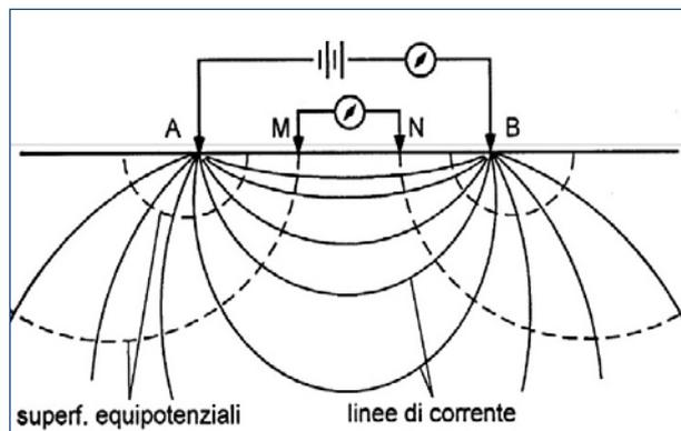
Figura 5 – Prospezione Geoelettrica
