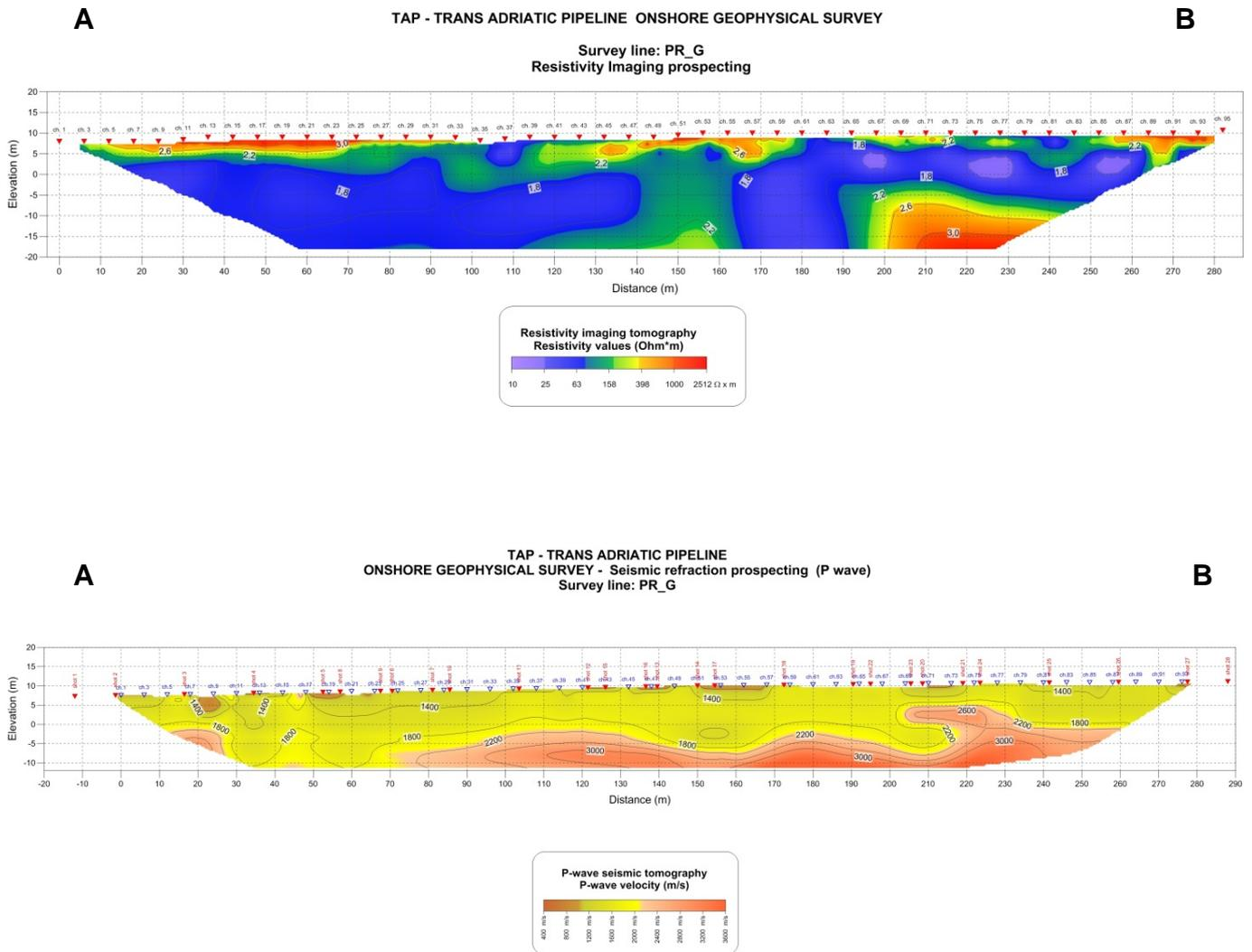
Figura 22 – Melendugno. TAP. Profilo PR\_G – prospezioni geoelettriche e sismiche a rifrazione.
