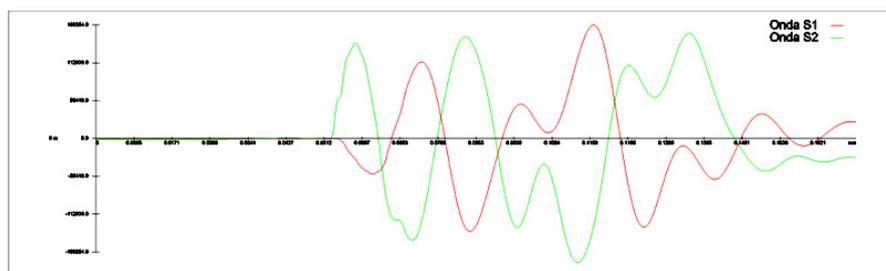
Figura 18 – Esempio di onda S ed individuazione del tempo di arrivo dell’onda di taglio (onda S).
