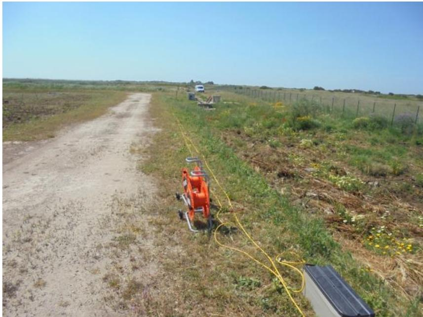
*Foto 3 - Melendugno. TAP. Prospezione geoelettrica. Profilo PR\_G.*
