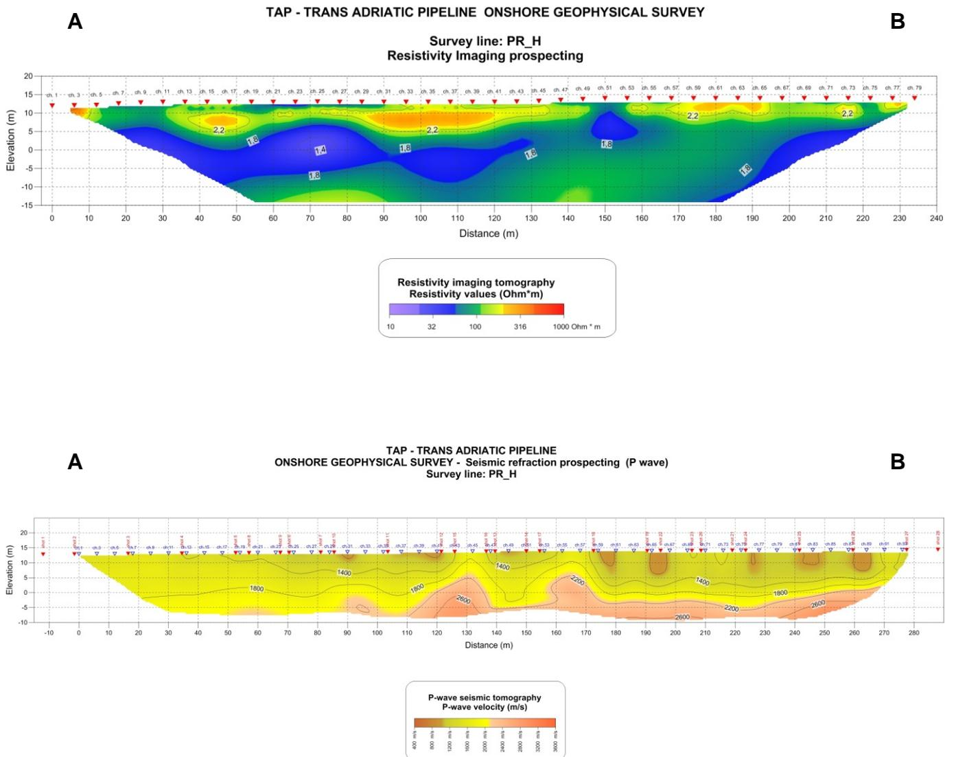
Figura 23 – Melendugno. TAP. Profilo PR\_H – proiezioni geoelettriche e sismiche a rifrazione.
