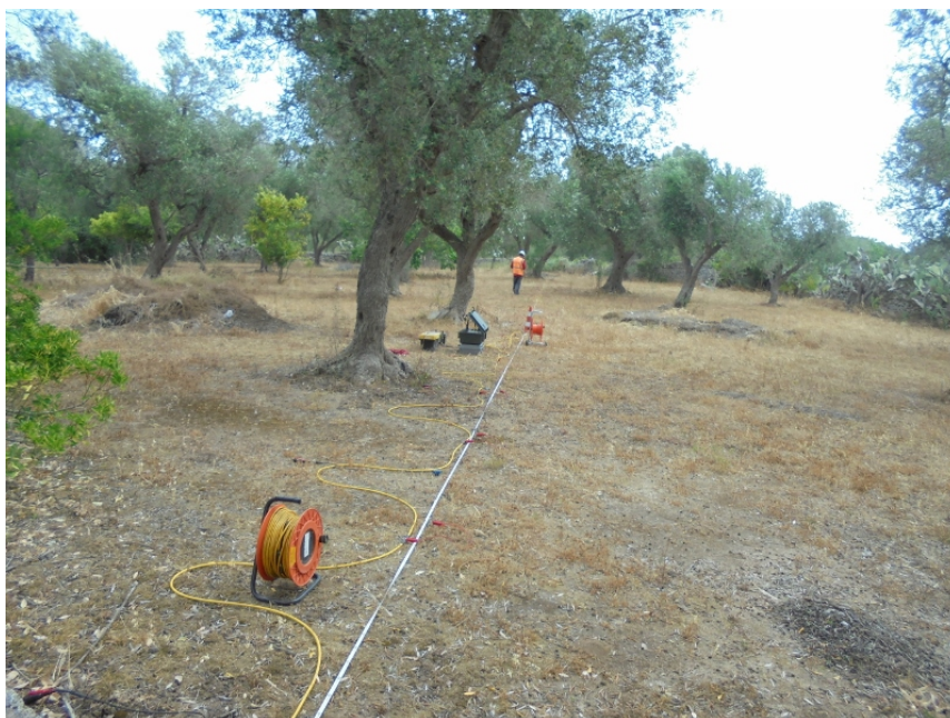
Foto 3 - Melendugno. TAP. Prospezione geoelettrica. Profilo PR03 .
