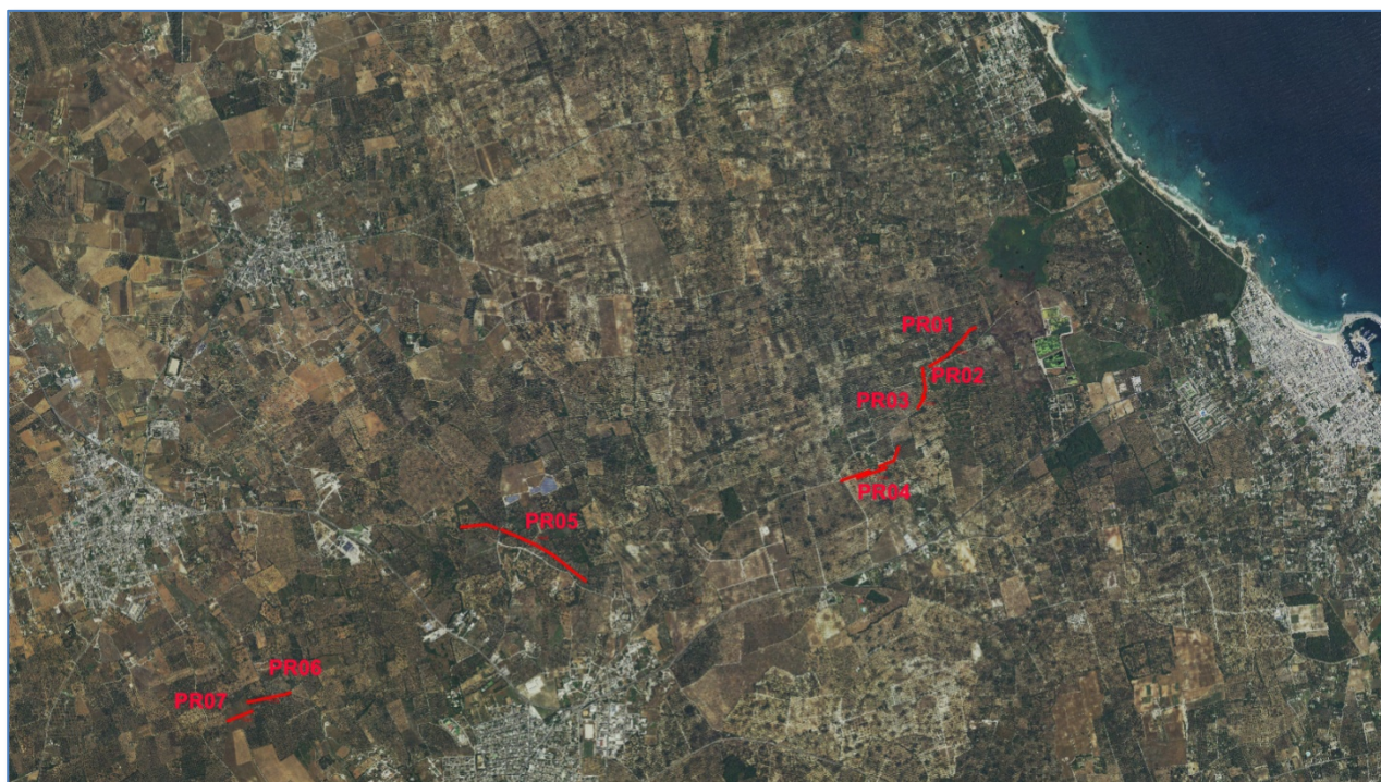
Figura 14 – Melendugno. TAP. Ubicazione delle prospezioni sismiche a rifrazione eseguite lungo il tracciato del gasdotto.
