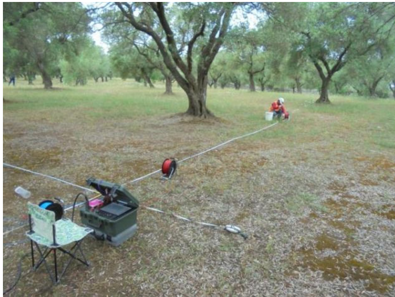
Foto 5 - Melendugno. TAP. Prospezione geoelettrica 1D VES. VES-2. Prospezioni eseguite parallelamente ed ortogonalmente al tracciato del gasdotto.
