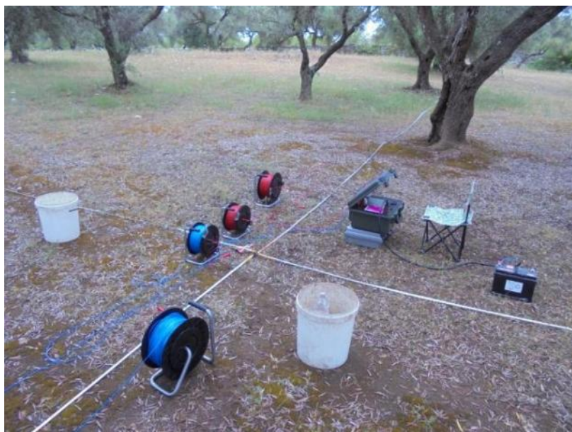
Foto 6 - Melendugno. TAP. Prospezione geoelettrica 1D VES. VES-3. Prospezioni eseguite parallelamente ed ortogonalmente al tracciato del gasdotto.
