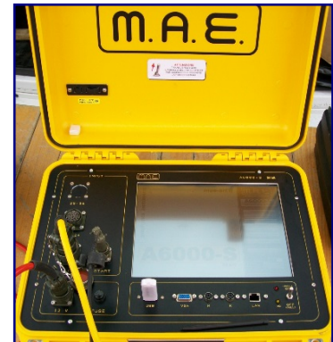
Figura 16 – Sismografo M.A.E. A6000-S.
