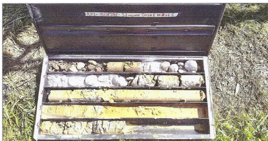
Foto 14 – Campionamento S2 inclinato
