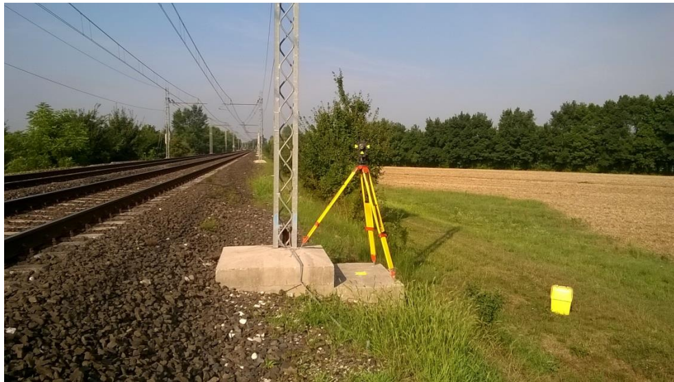
Figura 5-1 Materializzazione del punto 8000 della poligonale
