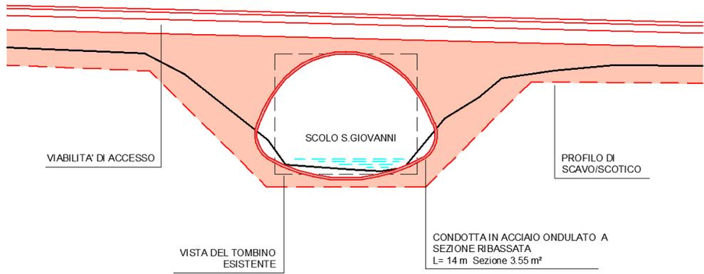
**Figura 7-7** Condotta in acciaio ondulato per l'attraversamento provvisorio dello scolo San Giovanni
