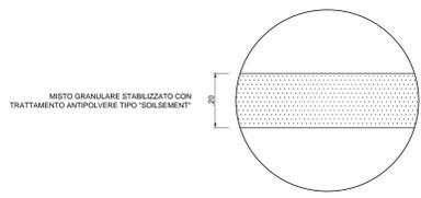
**DETTAGLIO "B" PAVIMENTAZIONE**
