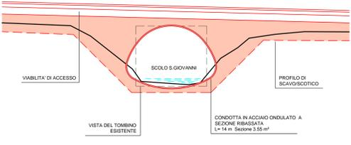
**PISTA DI CANTIERE SEZIONE TIPO**
