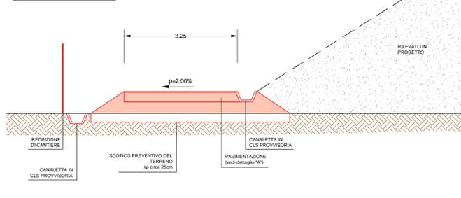
**VIABILITÀ DI ACCESSO AL CANTIERE SEZIONE TIPO**
