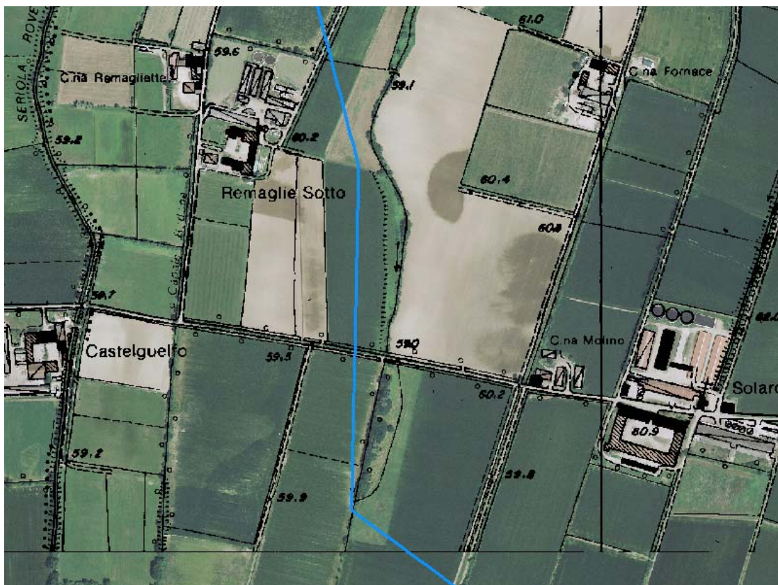
Fig. 2.3/B: Zona umida compresa fra C.na Remagliette e C.na Molino dove può essere adottata una fascia di lavoro ridotta a soli 8,5 m (in azzurro, la condotta "Allacciamento al Comune di Gottolengo DN 150 (12")" in dismissione).
