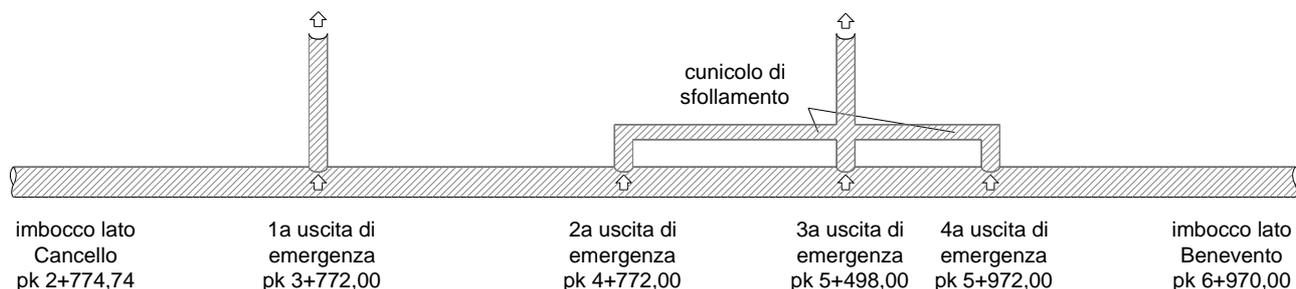
Fig. 13 – Rappresentazione schematica uscite di emergenza
