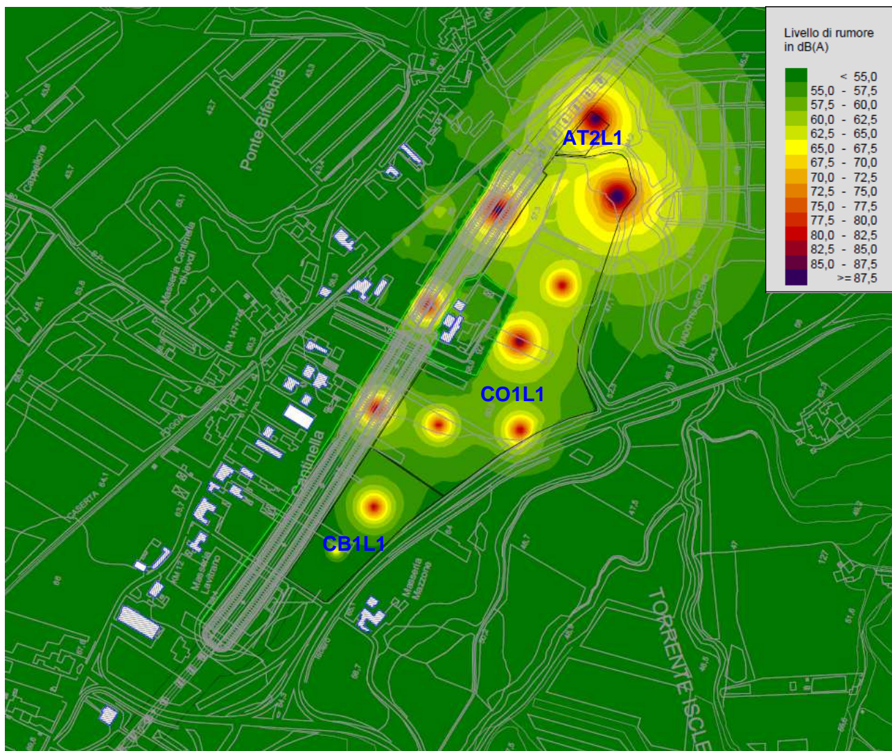
Figura 11-19: Realizzazione opere tra la pk 11+800 e la pk 12+700 con misure di mitigazione (barriera antirumore H=5 m)
