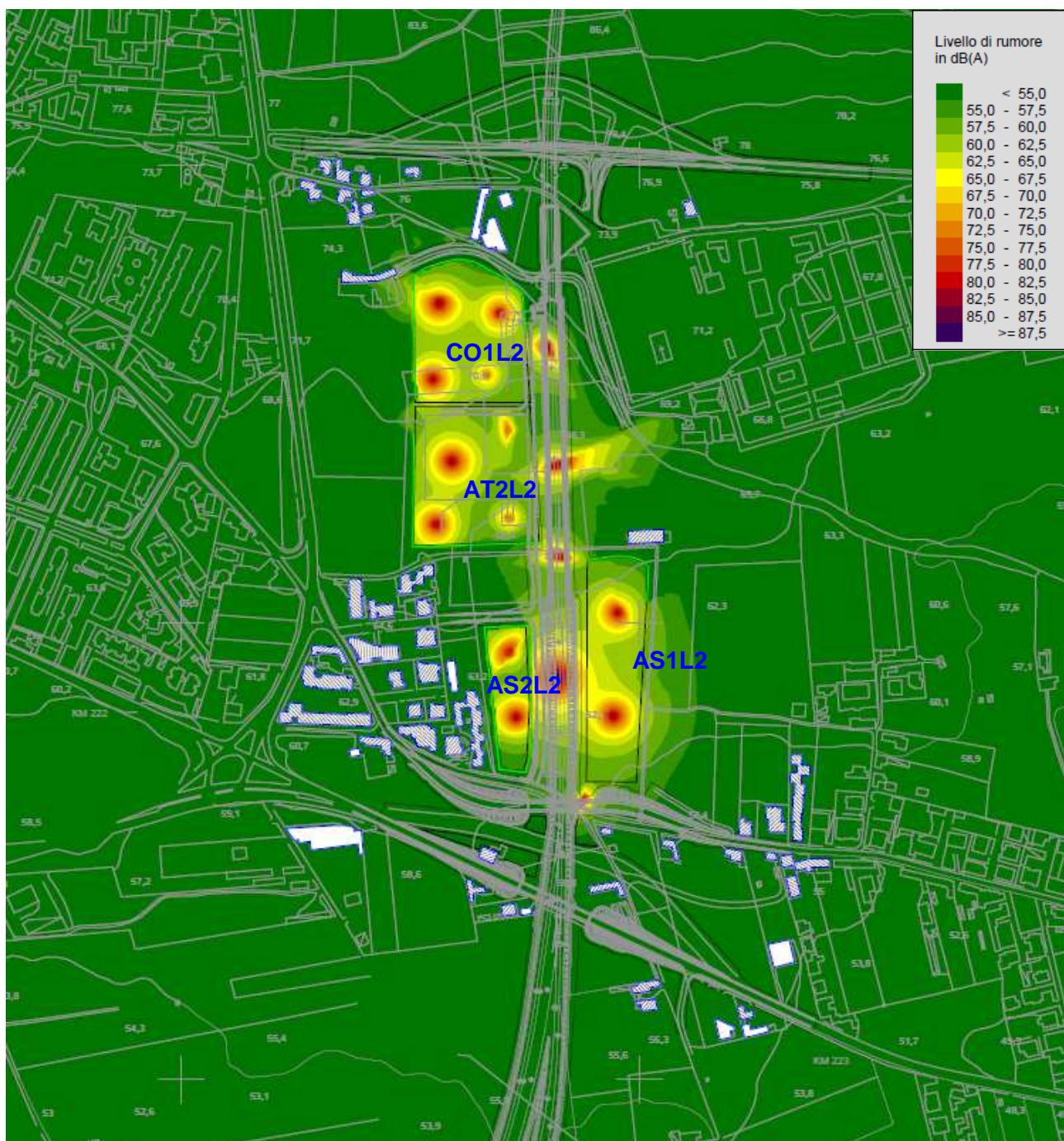
Figura 11-17 – Realizzazione opere tra la pk 2+200 e la pk 2+900 con misure di mitigazione (barriera antirumore H=5 m)
