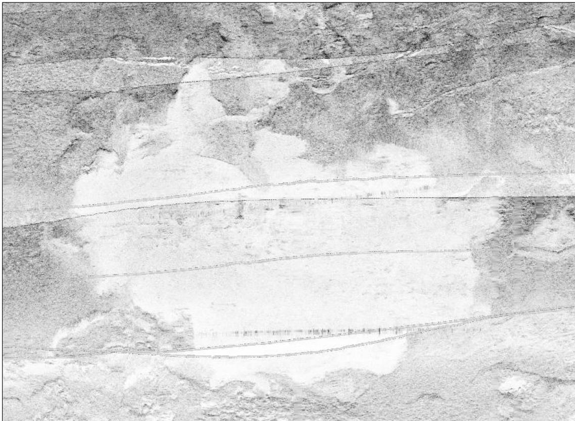
**Fig. 2.2a – Esempio di registrazione SSS: sedimenti fini (silt e argilla)**
