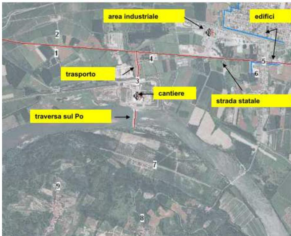
Figura 6-17 Localizzazione degli elementi considerati nel modello di simulazione acustica
