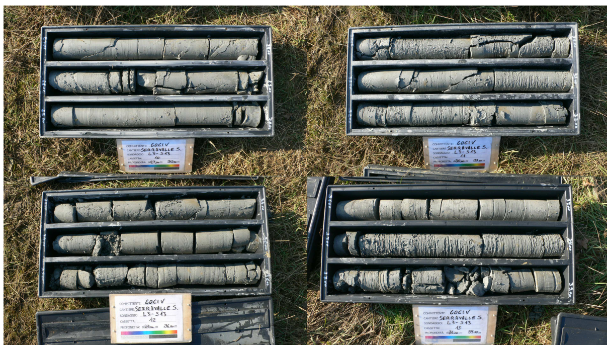
Figura 6-12. Sondaggio L3S13, passaggio dalla formazione delle aL ai cC .
