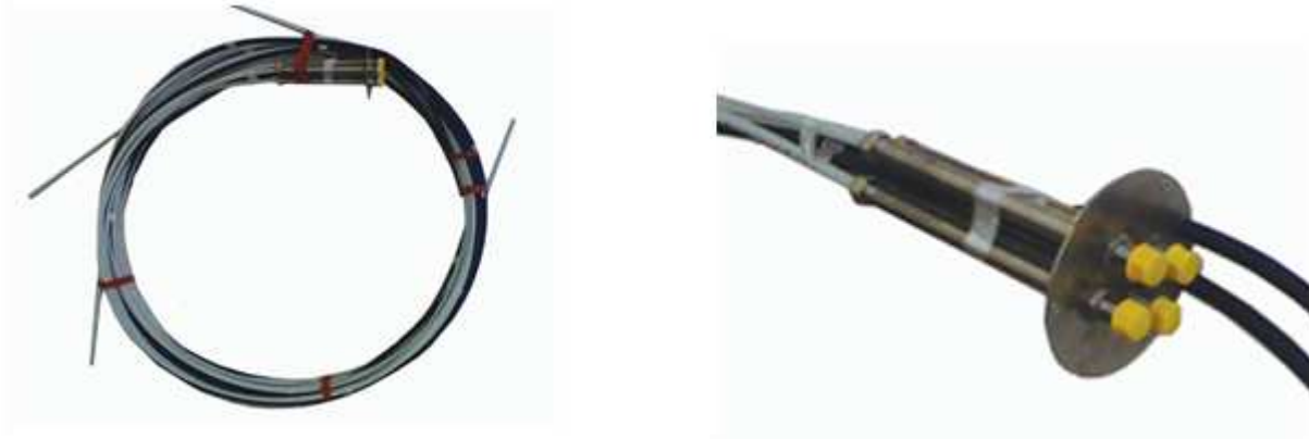
Figura 4-1 - Particolare dell'estensimetro e della testa
