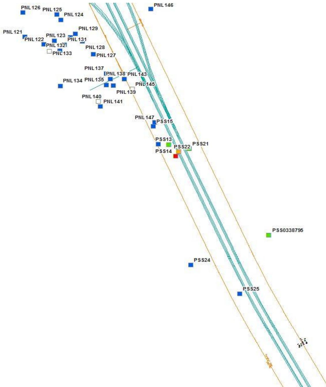
**Figura 9. Ubicazione dei pozzi e valori di pericolosità d'instesimento in riferimento alle WBS GN1BA e GN1CA. Colore rosso: pericolosità alta; colore arancione: pericolosità media; colore verde: pericolosità bassa; colore blu: pericolosità nulla o trascurabile; colore bianco: dato non disponibile.**
