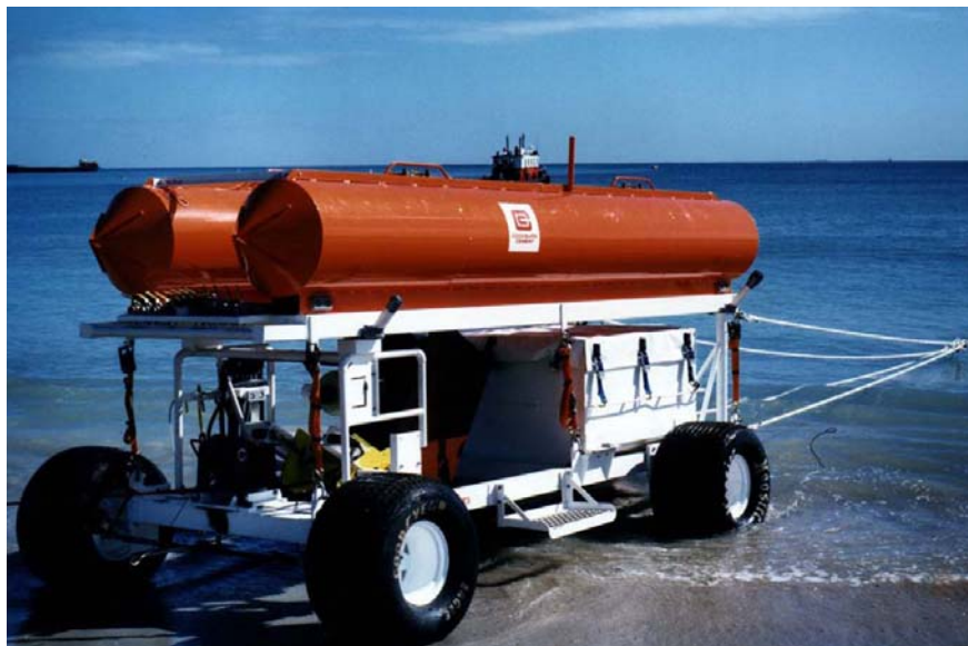
Figura 7.2: Esempio di Mezzo Sottomarino impiegato per il Reimpianto Automatizzato di Fanerogame, Ecosub I (Sito Web: Environmental Protection Authority of Western Australia, http://www.epa.wa.gov.au/ )
