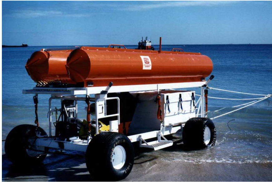
Figura 4.1: Esempio di Mezzo Sottomarino impiegato per il Reimpianto Automatizzato di Fanerogame, Ecosub I (Sito Web: Environmental Protection Authority of Western Australia, http://www.epa.wa.gov.au/ )
