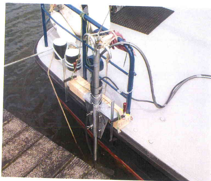
Figura 6: trasduttore SES 2000 installato a palo
