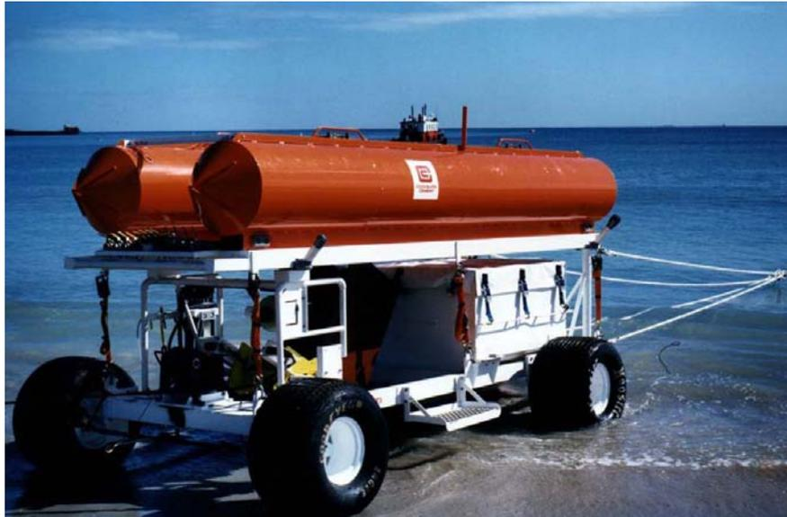
**Figura 2.1: Esempio di Mezzo Sottomarino impiegato per il Reimpianto Automatizzato di Fanerogame, Ecosub I (Sito Web: Environmental Protection Authority of Western Australia, <http://www.epa.wa.gov.au/>)**
