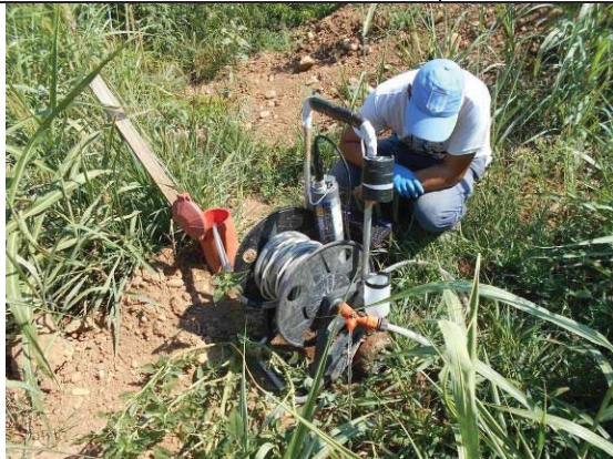
Punto AV-CO-SO1-BG3.2. Spurgo
