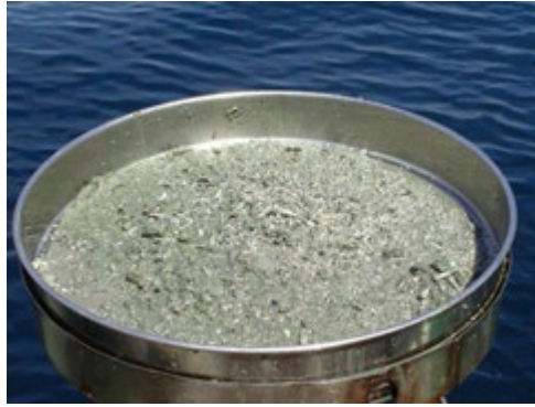
Fig. 2.6 - Campione di macrozoobenthos sul setaccio durante la fase di pulitura dai residui di sedimento.
