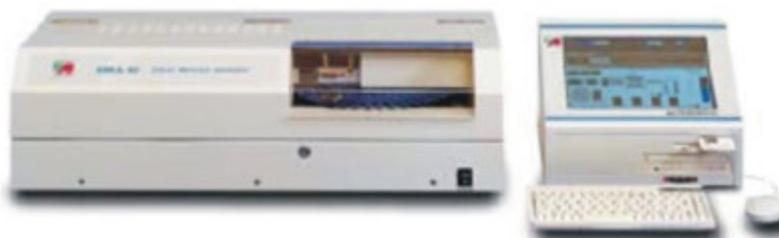
Spettrofotometro ad assorbimento atomico. Lunghezza d'onda 253.65 nm. Trattamento del campione tramite cicli di essiccamento e combustione totalmente programmabili via terminale con schermo touch-screen. Lampada impiegata a vapore di mercurio a bassa pressione. Calibrazione eseguita con soluzioni standard o materiali di riferimento solidi.
