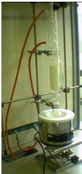
**Materiale:** Apparato elevatore, isomantello, pallone da 250 ml, un apparato di Soxhlet con refrigerante apposito, un ditale di carta, pinze e morsetti, due tubi di gomma, moderatore di ebollizione (sfere di pyrex), cilindro graduato da 250 ml, solvente organico d'estrazione, cilindretto graduato da 10 ml, pipette Pasteur, cristallizzatore, piastra riscaldante, ancorotta magnetica, imbuto, tettarelle, cotone, provetta o protettone da 250 ml.
