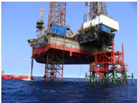
**Fig. 1.1** - Settembre 2007. Jacket della piattaforma Tea e jack-up per i lavori di installazione e perforazione.
