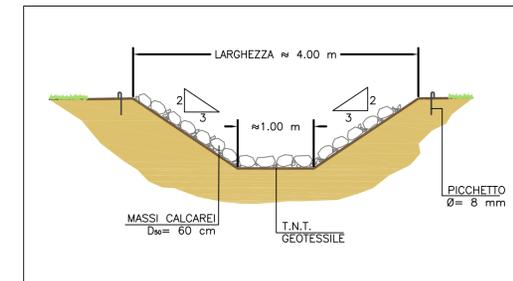
TRACCIATO DEL FOSSO COMPRESO ALL'INTERNO DELLA PISTA 8A. RIPRISTINO CON RISAGOMATURA E RIVESTIMENTO CON MASSI D<sub>50</sub>=60 cm CEMENTATI E REGOLARIZZATI IN SUPERFICIE
