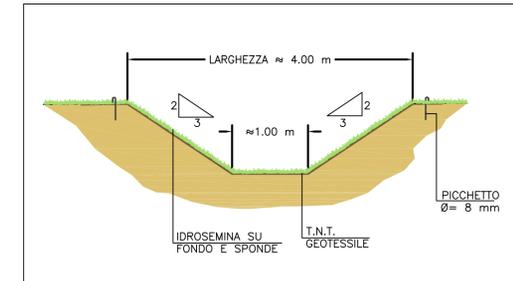
TRACCIATO DEL FOSSO COMPRESO ALL'INTERNO DELL'AREA ST2. RIPRISTINO CON SAGOMATURA DEL FOSSO ED INSERIMENTO DI GEOTESSILE ED IDROSEMINA
