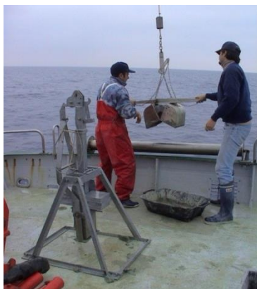
Fig. 2.3 – Box-corer utilizzato per le indagini fisiche e chimiche dei sedimenti (in primo piano) e recupero della benna Van Veen utilizzata per lo studio della comunità bentonica.
