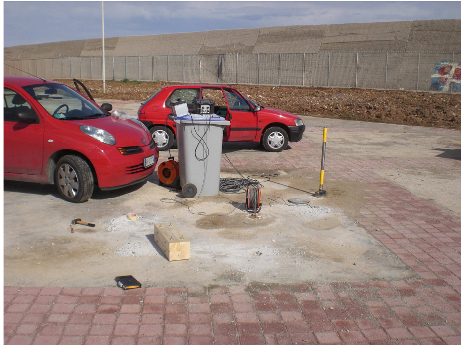
Down-hole DH2 eseguito in foro di sondaggio S2
