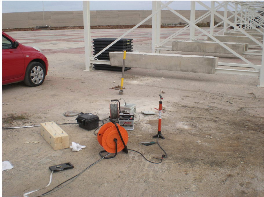
Down-hole DH1 eseguito in foro di sondaggio S1
