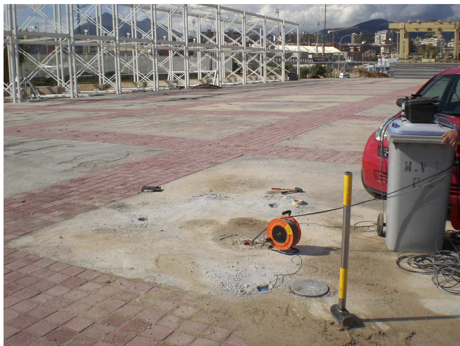
Particolare del down-hole DH2 eseguito in foro di sondaggio S2
