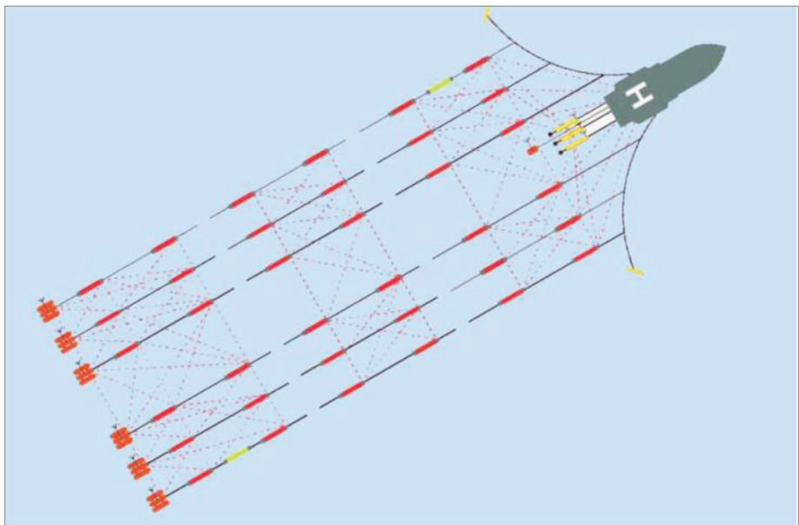
Figura 10 - Configurazione Air Gun Array con volume totale airgun di 3090 pollici cubici (circa 50 litri). (American Cetacean Society, www.acsonline.org ).
