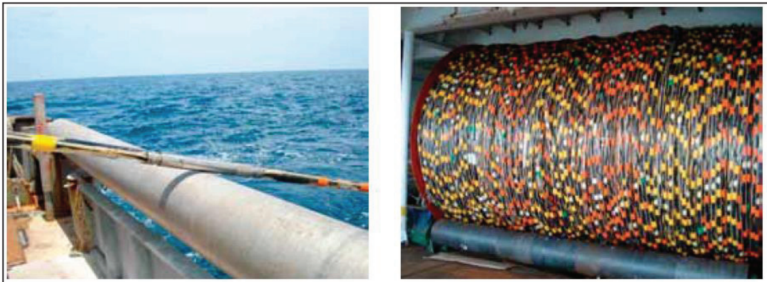
Figura 11 - Esempio di Cavo Sismico o Streamer (OGP, 2011)
