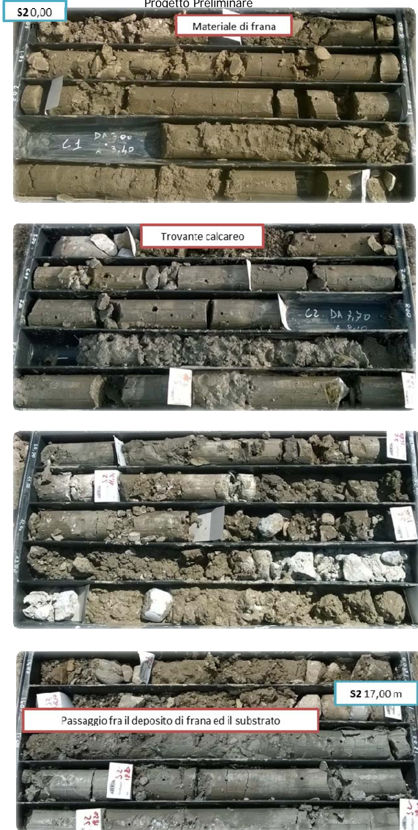
Foto 4– Sondaggio S2: depositi di frana
