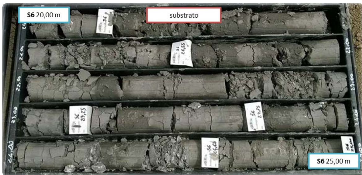
Foto 5 – Sondaggio S6: substrato costituito dal Flysch Numidico
