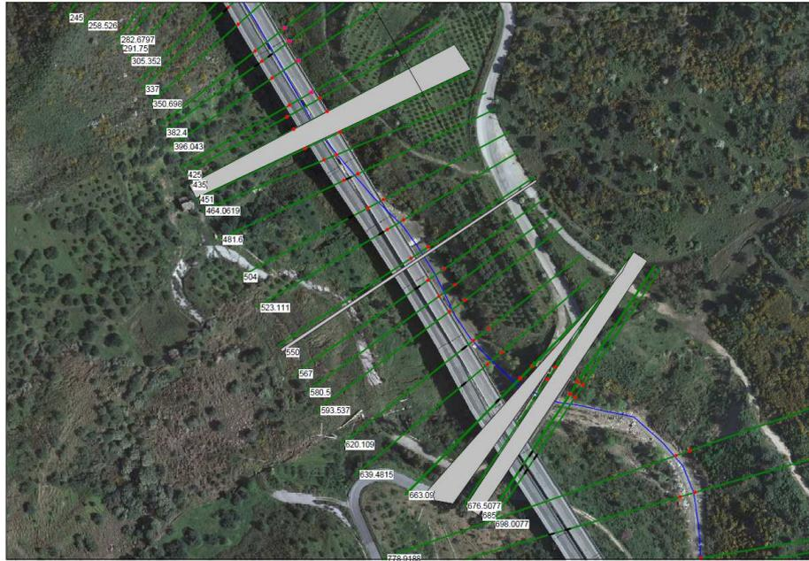
Fig. 7– Studio di compatibilità idraulica – Ubicazione sezioni trasversali di calcolo del tratto degli interventi in progetto
