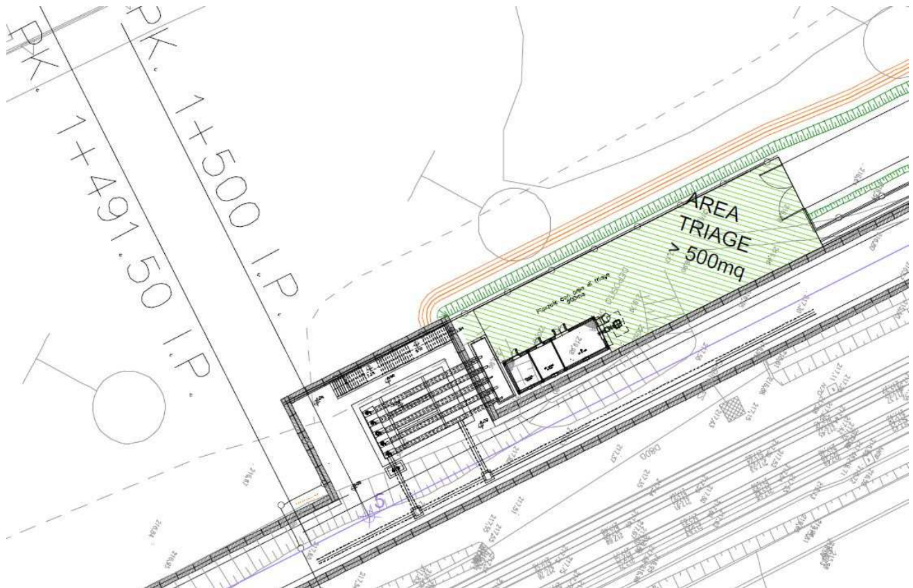
Figura 29: Schema planimetrico uscita di sicurezza presso l'imbocco della galleria di interconnessione di Novi Ligure binario pari
