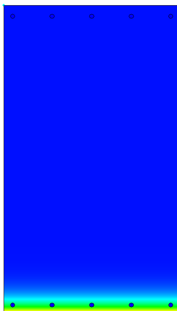
Figura 196 – Distribuzione temperatura all'interno della sezione di spessore 190 cm (t = 120 min curva UNI11076)
