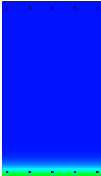
Figura 195 – Distribuzione temperatura all'interno della sezione di spessore 190 cm (t = 120 min curva EUREKA)
