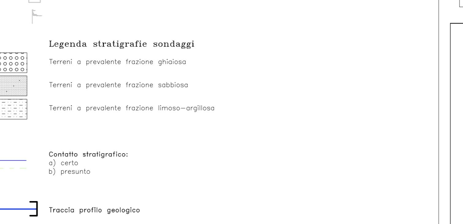
**Nota:** Il profilo geologico è eseguito 35 m in dx rispetto all'asse autostrade. La traccia lungo la quale è stato realizzato il profilo è indicata in piantina mediante una linea blu, sul profilo viene inoltre riportata la proiezione della livellata di progetto mediante una linea tratto-punto.
