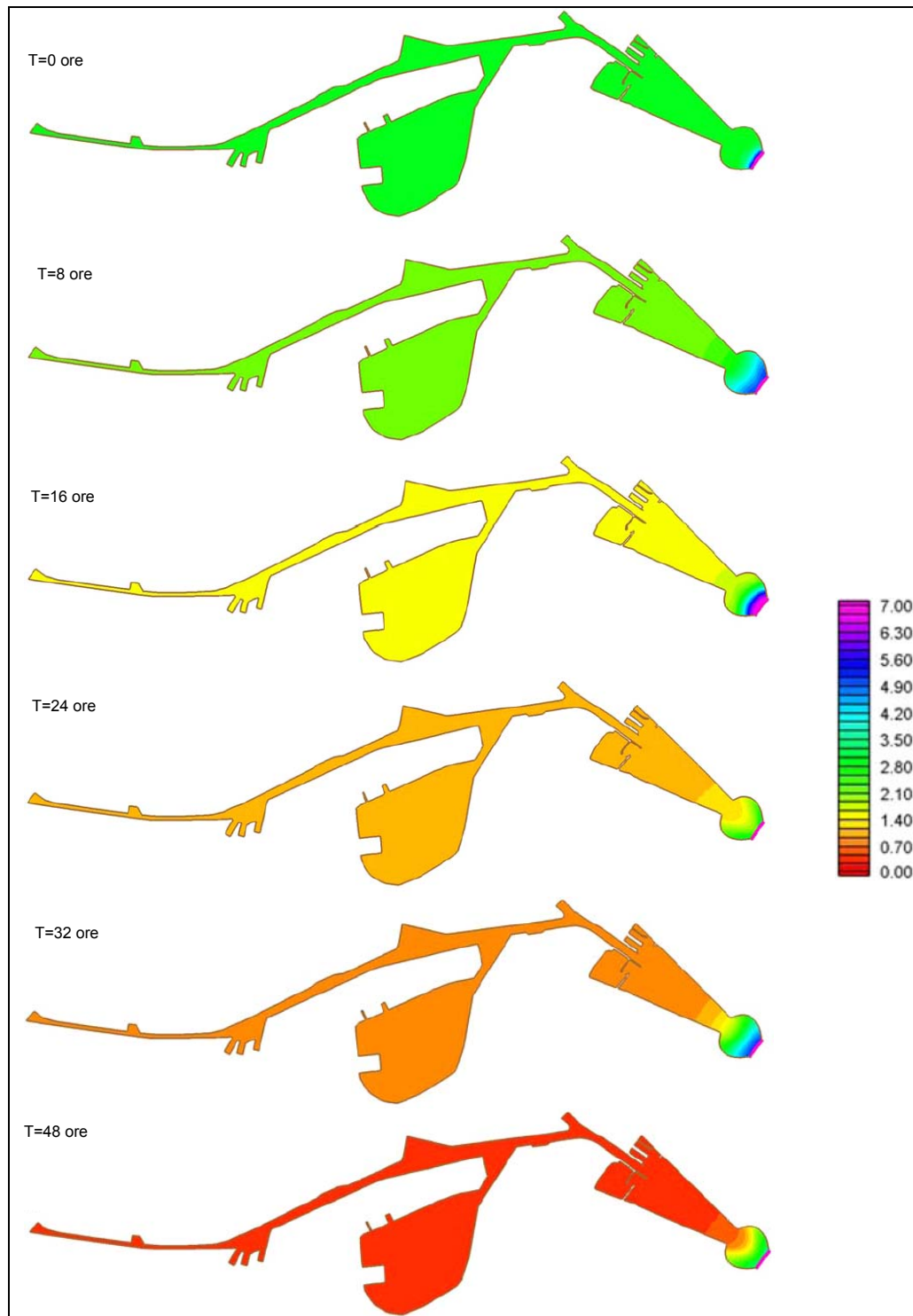
Figura 1-49: Simulazione delle concentrazioni dell'ossigeno disciolto con le opere di difesa esterne (valori in mg/l) (Modimar, 2007)
