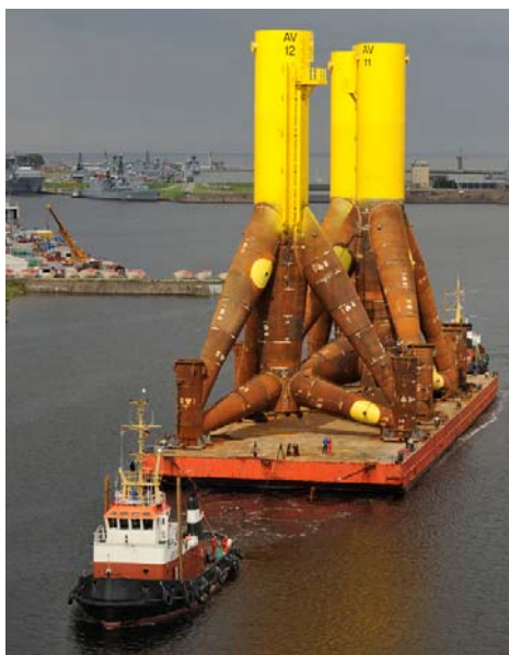
Figura 2-6 trasporto di 2 fondazioni a tripode tramite chiatta e rimorchiatore [ http://www.alpha-ventus.de ]
