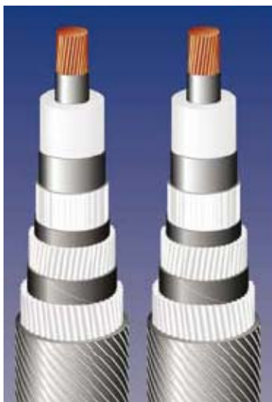
Figura 2-13 Sezione tipica del cavo marino polimerico 150 kV DC unipolare in rame, con armatura in acciaio
