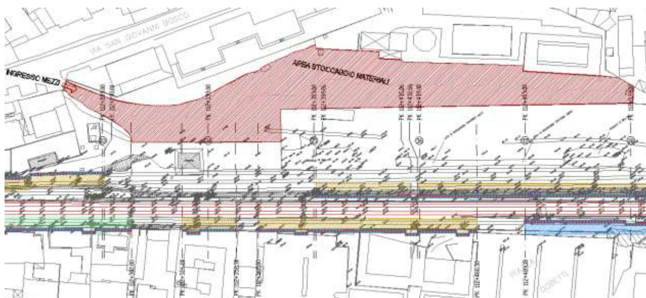
Figura 5-20 Stralcio planimetrico Area Cantiere Stoccaggio materiali
