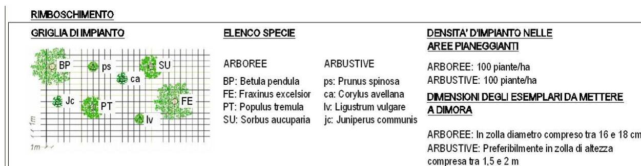
**Figura 3 Sesto d'impianto e specie di previsto utilizzo per il recupero dell'area di cantiere**
