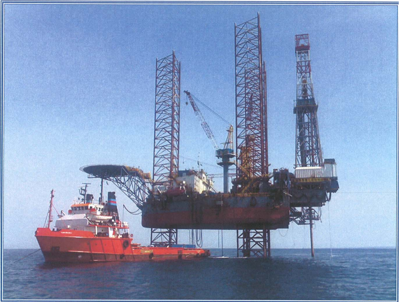
Figura 2.4.a – Foto dell'impianto di perforazione Jack-up "G.H. GALLOWAY" con nave appoggio
