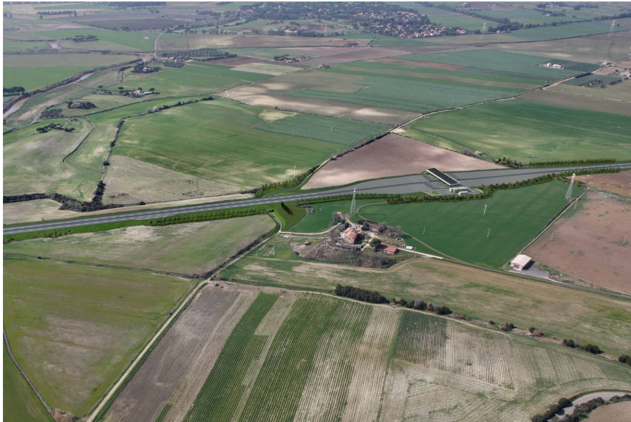
Figura 3 – La barriera di esazione, contornata da filari arborei polispecifici, con funzione di schermatura visuale nei confronti dell'abitazione posta in primo piano; per contro la visuale degli utenti autostradali spazia verso la campagna che li divide dal mare.
