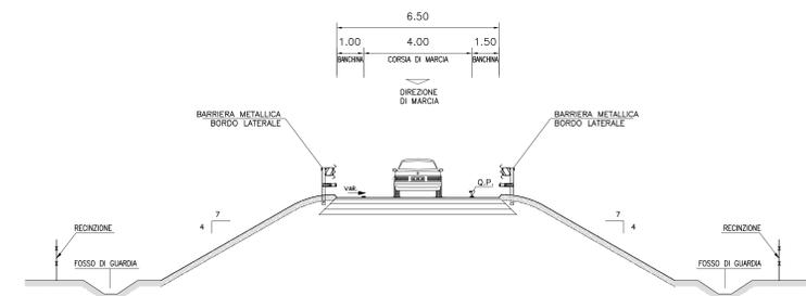
SEZIONI DI PROGETTO IN RILEVATO A CARREGGIE AFFIANCATE IN RETTIFILLO
