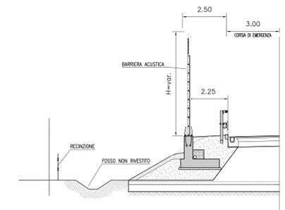
SEZIONE DI PROGETTO IN RILEVATO A CARREGGIE AFFIANCATE IN CURVA
