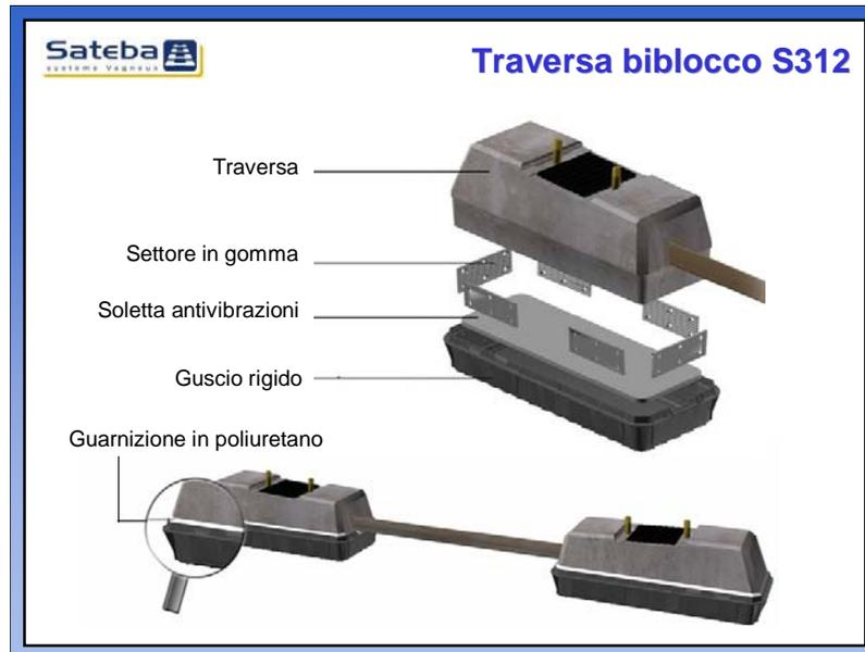
Il sistema si compone di una traversa bi-blocco le cui tolleranze geometriche sono fortemente ridotte a  $\pm 1$  mm invece di  $\pm 3$  mm richiesti dalla BNCF 51-101, collocata in due gusci rigidi in materiale sintetico, dalle tolleranze geometriche ugualmente ridotte.
