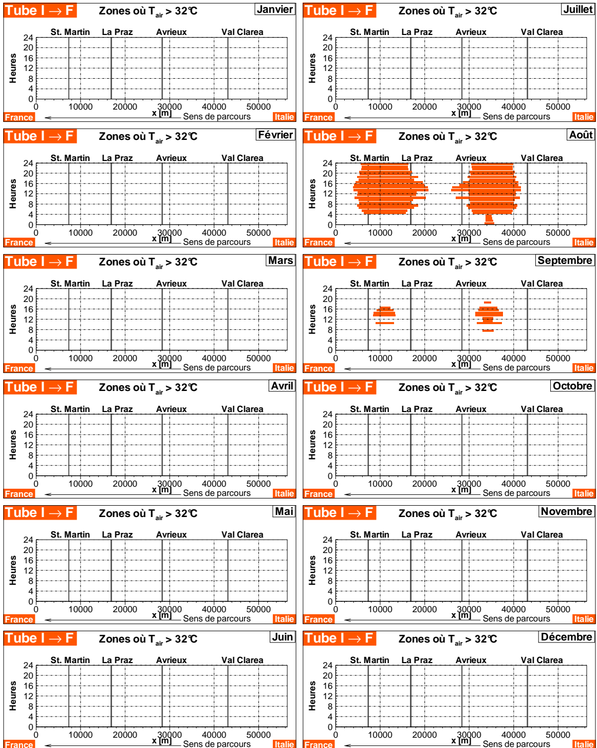
Figure 28 Dans le Tube 2 I → F après 30 ans d'exploitation, zones où la température de l'air dépasse la température de consigne de 32°C.
