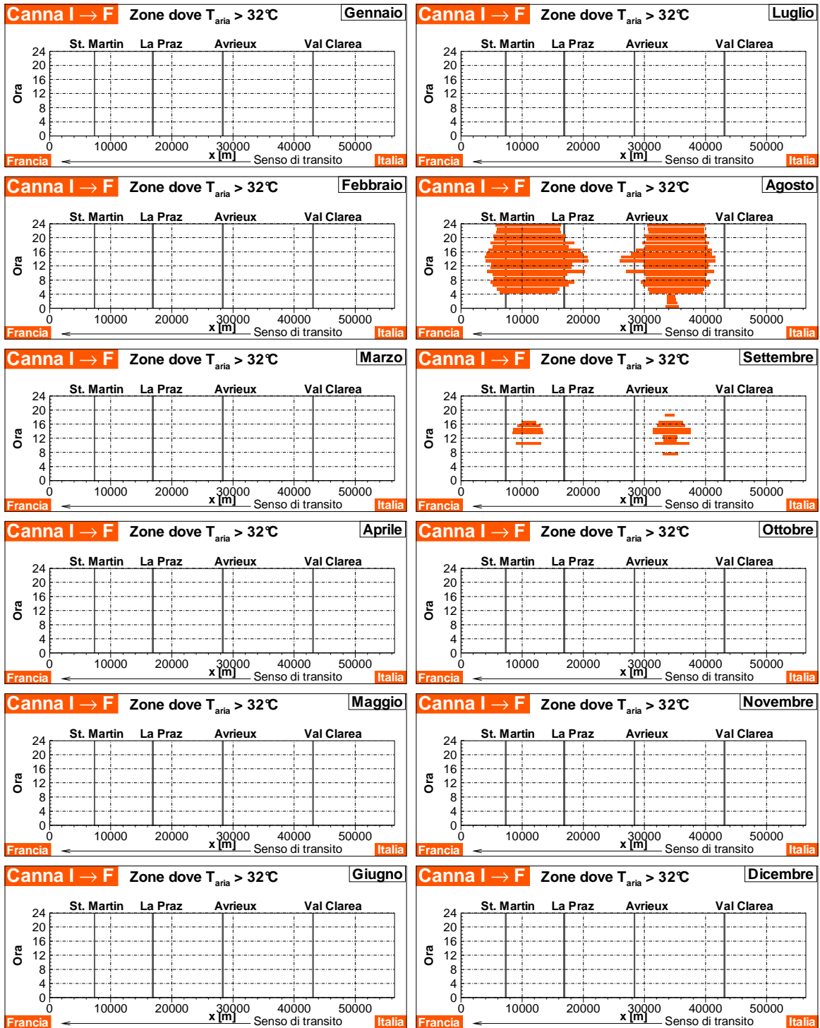
Figure 8 Nella Canna 2 I → F dopo 30 anni d'esercizio, zone in cui la temperatura dell'aria supera la temperatura di consegna di 32°C.
