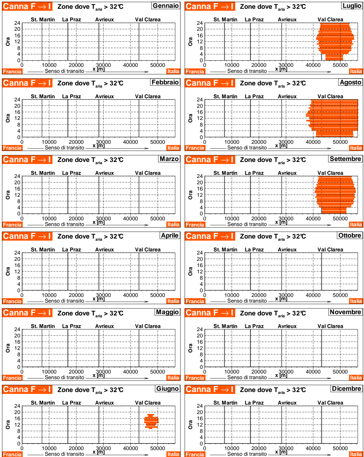
Figure 6 Nella Canna 1 F → I dopo 30 anni di esercizio, zone in cui la temperatura dell'aria supera la temperatura di consegna di 32°C.
