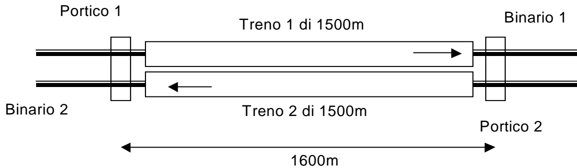
Figura 8 : Messa in opera di due portali per rilevare i punti caldi qualsiasi sia l'interasse
