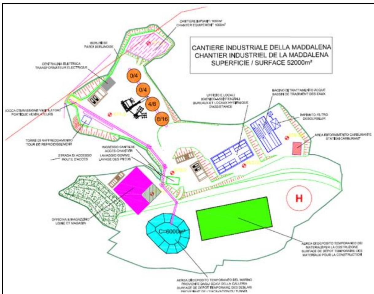
Figura 4 - Layout del cantiere della Maddalena
